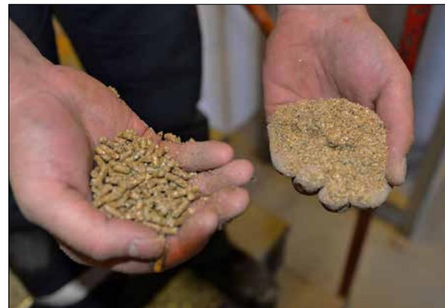
Das Futter wird gemahlen und dann zu kleinen Würfeln (links) gepresst.
