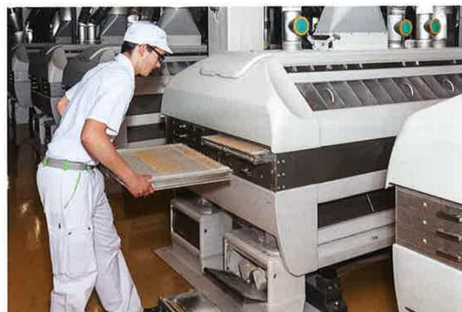
Abb. 3: Lernender Müller beim Wechsel der Siebe an der Griesputzmaschine
